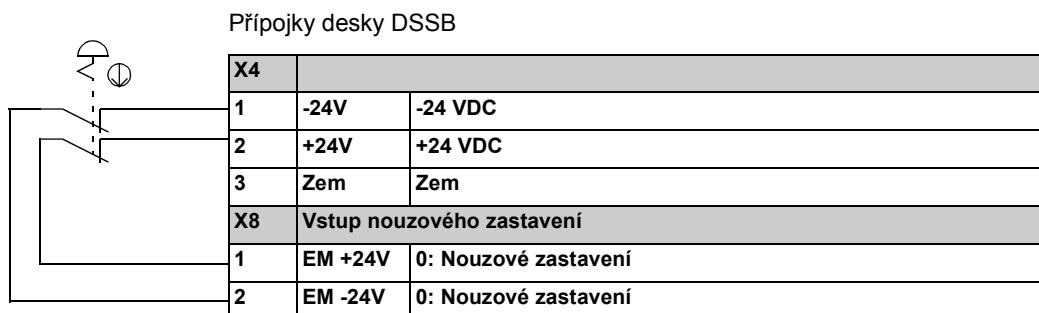
Tlačítko nouzového zastavení zapojené do desky DSSB
